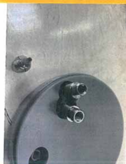
8. Łączniki wykonane metodą frezowania i metoda hybrydową (Frezarka Arum 5x200 i drukarka SLM RITON 150 Titanium).
